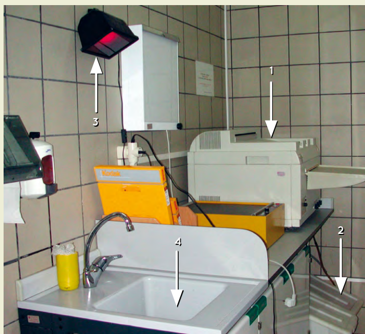
FIGURA 1.24 Camera oscura per lo sviluppo delle pellicole radiografiche: 1: sviluppatore automatico; 2: vassoi per la raccolta delle soluzioni di sviluppo; 3 lampadina a luce rossa che può rimanere accesa durante le operazioni di sviluppo; 4: lavandino.
