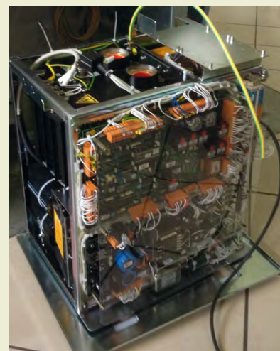
FIGURA 17 Immagine di un generatore di raggi X in fase di installazione. ►
