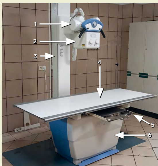
◀ FIGURA 14 Apparecchiatura a raggi X per uso veterinario. 1: tubo radiogeno protetto dal collimatore; 2: collimatore ad apertura variabile; 3: colonna di scorrimento del tubo; 4: tavolo paziente; 5: vassoio della cassetta/pannello rivelatore; 6: armadio del generatore.
