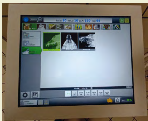
FIGURA 18 Console di controllo digitale: i parametri di esposizione vengono selezionati tramite un software utilizzando un monitor touch screen.
