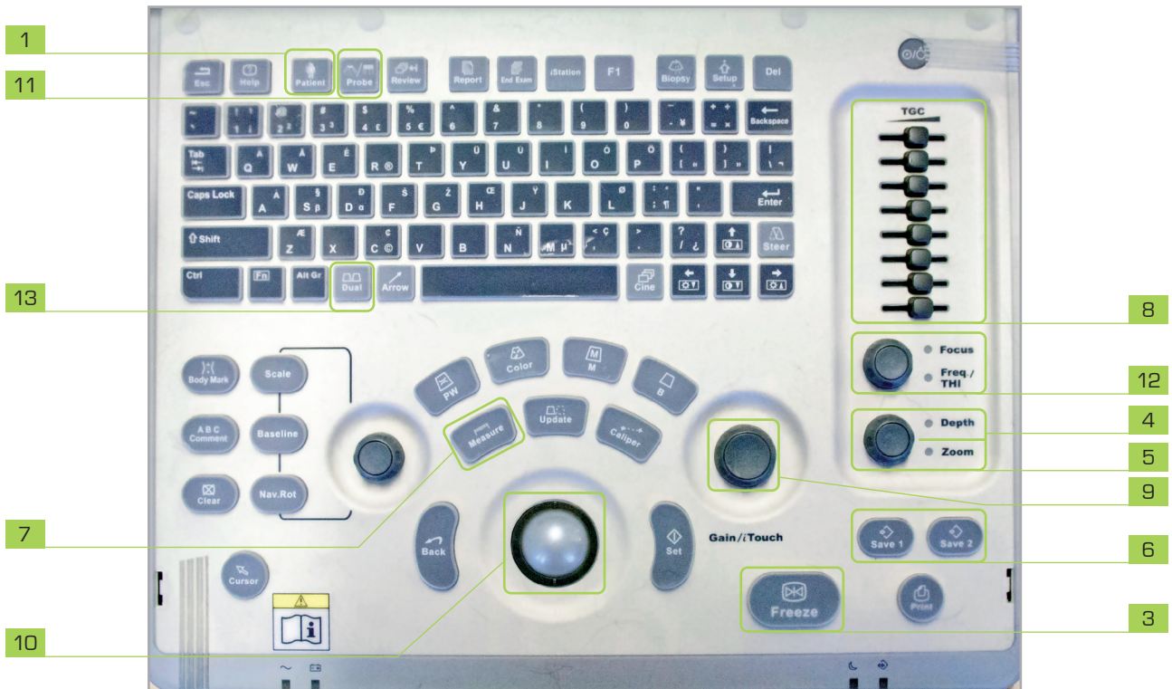
Figura 1.1 Console di un ecografo portatile. Sono indicati i pulsanti e le manopole più comunemente utilizzati.
